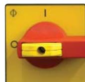
En la posición "0" la destructora de documentos está apagada. El interruptor principal se puede asegurar con un candado. En la posición "I" la máquina está dispuesta para el funcionamiento.
