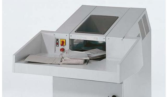
Coloque el material a triturar sobre la plataforma de carga y de allí dosifíquelo a la cinta transportadora de entrada.
